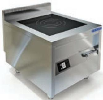
Одноконфорочные индукционные плиты предназначены для приготовления пищи в производственных масштабах. Благодаря высокому КПД — 90% — выгодно отличаются от газовых и электрических аналогов, КПД которых равен 60% и 55% соответственно.
