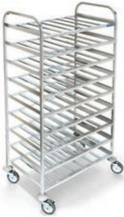
В ассортименте имеются стеллажи-шпильки для подносов, гастроемкостей, противней и хлебных лотков. Стеллажи имеют цельносварную конструкцию, все модели оснащены обрешиненными поворотными колесами, имеющими диаметр 125 мм. Два из четырех колес оснащены тормозом.
