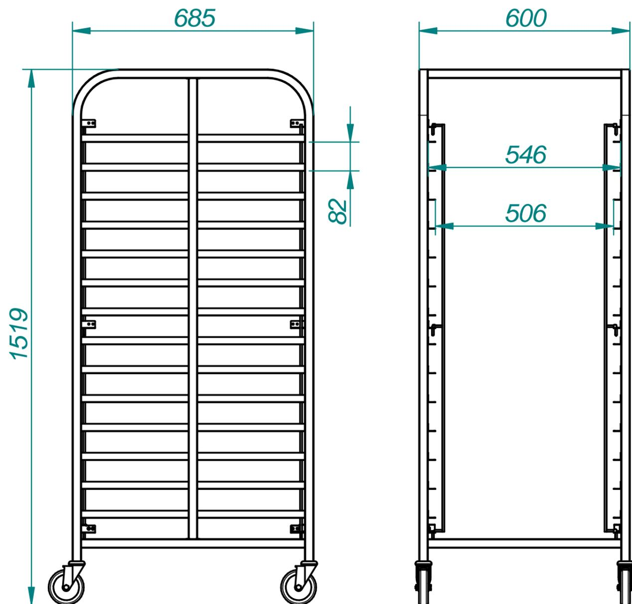
Тележка-шпилька ТШГ-14-2/1 является вспомогательным оборудованием для предприятий общественного питания и используется для установки и транспортировки до 14-ти gastronormов размером GN 2/1. Имеет поворотные колеса, два из которых оборудованы стопором. Тележка-шпилька изготовлена из нержавеющей стали.
