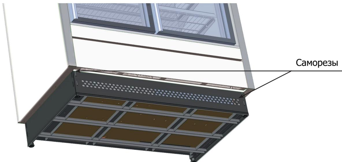
1.2 Снять фронтальную панель согласно иллюстрации:
