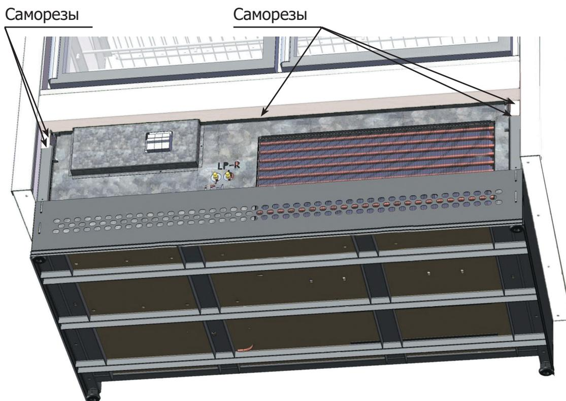
2.2 Снять панель носика согласно иллюстрации:
