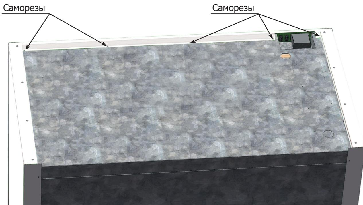
3.4 Снять козырек с витрины согласно иллюстрации:
