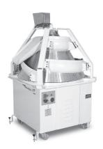
Машина подходит для округления мягкого теста, предварительно разделенного на заготовки определенной массы. Формование производится между вращающимися конусами и двумя вогнутыми спиралями с тефлоновым покрытием, прикрепленным к конусу. Кусочки теста получаются идеально сферической формы. Машина поставляется в комплекте с независимым электрическим мукопосыпателем.
