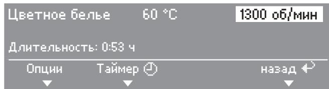
Вращением мультифункционального селектора можно выбрать различные компоненты программы, температуру, скорость отжима. Выбранный компонент выделяется. При нажатии мультифункционального селектора компонент выбирается, и открывается соответствующее подменю.
