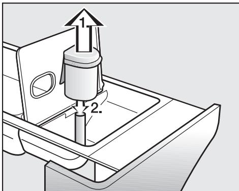
Особенно тщательно почистите сифон и канал кондиционера после неоднократного пользования жидким крахмалом. Жидкий крахмал приводит к склеиванию.
