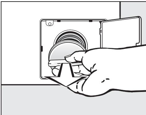
**⚠** Если сливной фильтр не будет установлен и плотно завернут, то вода будет вытекать из стиральной машины.
