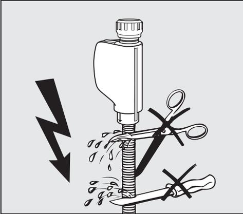
⚠ Заливной шланг **нельзя** укорачивать или повреждать, так как в нём имеются детали, находящиеся под напряжением (см. рисунок).
