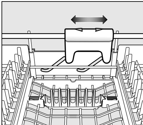
Для того чтобы получить больше места в выдвижном поддоне для больших столовых приборов, вы можете эту часть переставить выше с помощью жёлтого фиксатора.
