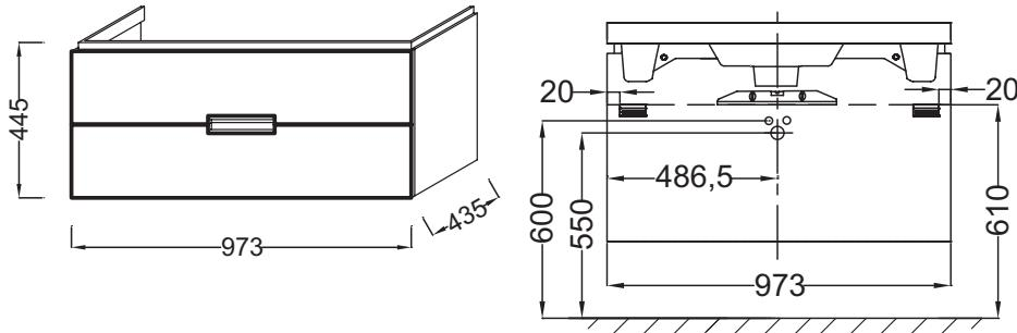
Спецификация продукта: Мебель для раковины 100 см. EB1136. Коллекция: REVE. РАЗМЕРЫ (СМ): 97 x 43,50 x 44,50 см. ВЕС: 25 кг. МЕСТО ДЛЯ ХРАНЕНИЯ: 2 выдвижных ящика с механизмом «плавное закрывание». РЕШЕНИЕ ХРАНЕНИЯ: Выдвижные ящики. ПРОДУКТ В КОМПЛЕКТЕ: (смеситель и раковина заказываются отдельно). РУЧКИ: Встроенные. ВНУТРЕННЯЯ СИСТЕМА ХРАНЕНИЯ: 2 съемных поддона для аксессуаров. ФИКСАЦИЯ: Установщику понадобится набор крепежей для монтажа на стену.
