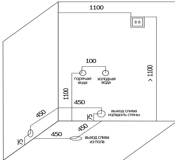
• Для монтажа и последующего обслуживания требуется свободное пространство по двум задним сторонам кабины не менее 50 см для обеспечения доступа ко всем узлам и агрегатам. Высота потолка в помещении должна обеспечивать зазор между крышей кабины и потолком не менее 10-15 см.
