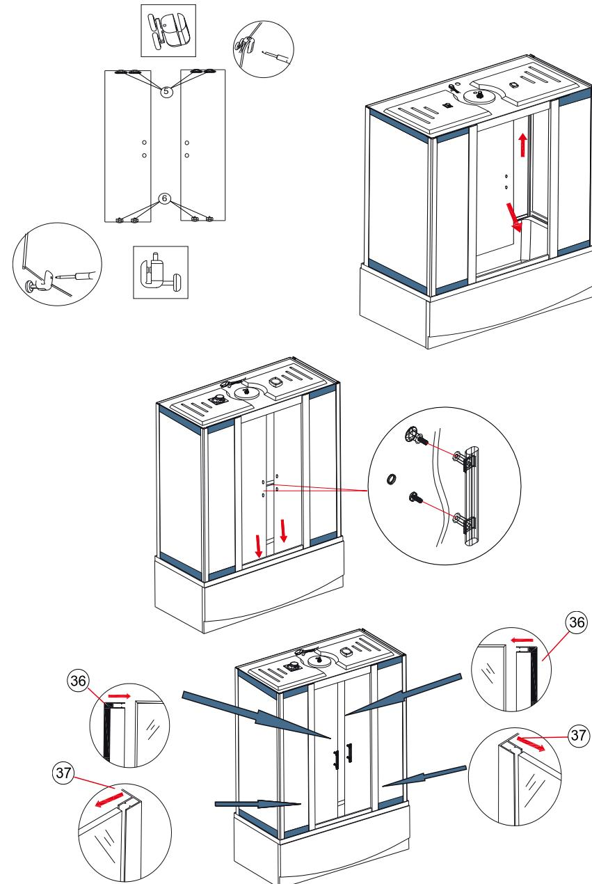
Схема сборки каркаса и установки передних, боковых стекол и центральной панели
