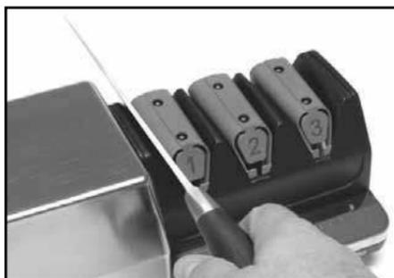
Рисунок 5. Устройство 1. Вставьте лезвие в паз между угловой направляющей и прижимной пружиной. Чередуите левый и правый пазы.
