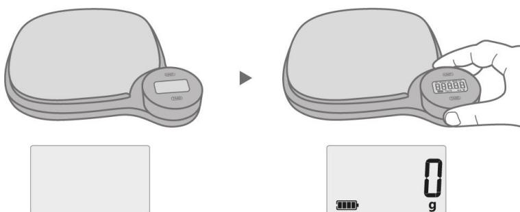
Draai de knop met de wijzers van de klok mee tot er 0 in het display verschijnt en de condensator door dynamotechnologie volledig is opgeladen.
