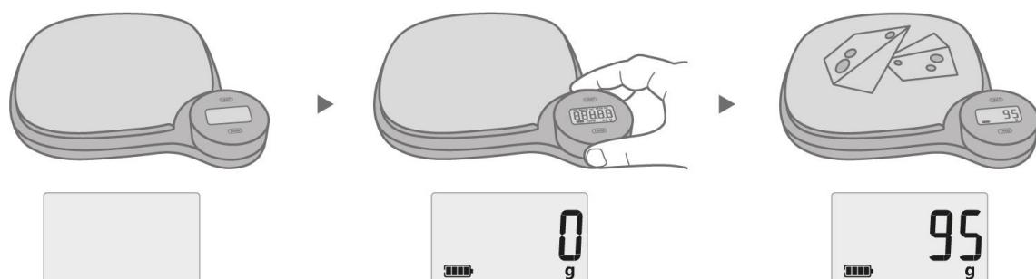
Поместите весы на твердую и ровную поверхность. Поворачивайте регулятор по часовой стрелке до тех пор, пока не увидите на дисплее значение 0. Поместите продукты на весы и их вес отобразится на дисплее.
