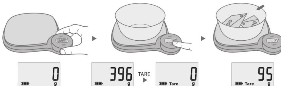
Plaats een container op het weegvlak, het display toont het gewicht van de container. Druk op de toest TARE, op het display op nul. Dus het gewicht van de container verwijderd en u kunt weegt de inhoud van de container.
