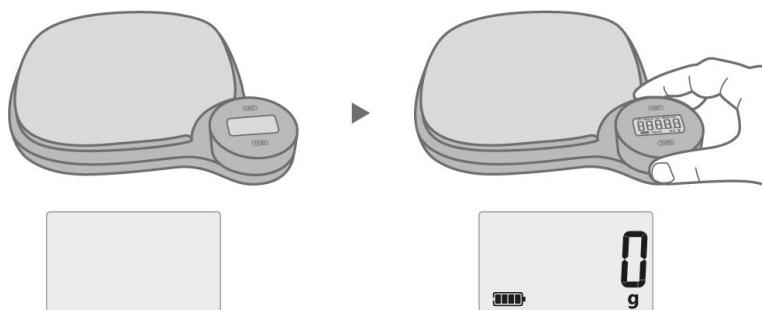
Ruotare il pomello in senso orario finché sul display appare 0; ciò significa che tramite tecnologia a dinamo il condensatore è completamente caricato.
