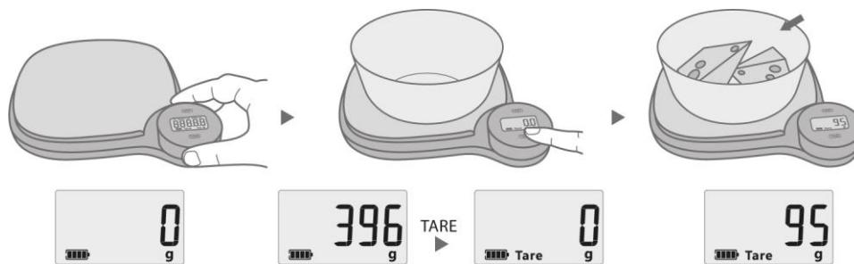
Stellen Sie einen Behälter auf die Wiegefläche, das Display zeigt das Gewicht des Behälters an. Drücken Sie die Taste TARE, das Display zeigt null an. So ist das Gewicht des Behälters gelöscht und Sie können den Inhalt des Behälters wiegen. Wenn Sie den Behälter entnehmen, zeigt die Waage das negative Gewicht, drücken Sie TARE und das Display zeigt nach 2 Sekunden Null an.
