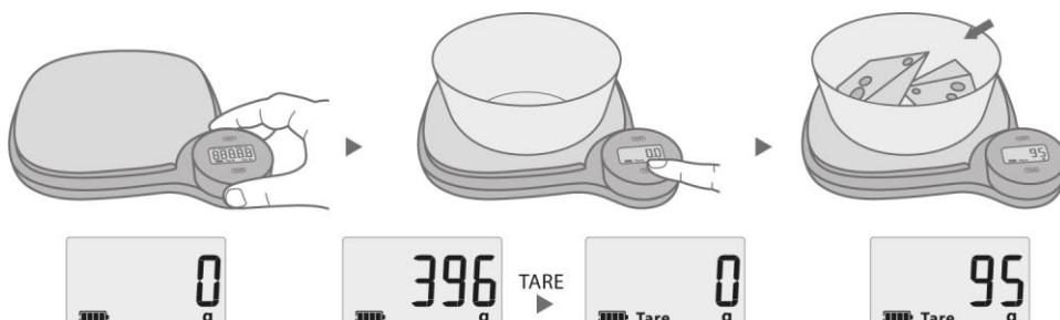
Posizionare un contenitore qualsiasi sul piatto di pesatura. Sul display viene visualizzato il peso del contenitore.
