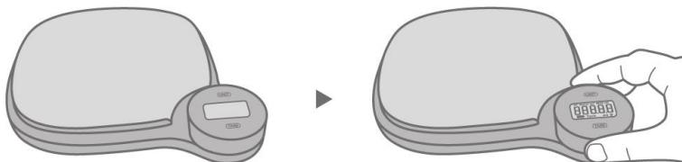
Gire el selector a derechas hasta que en la pantalla se muestre la indicación 0 y, por tanto, el condensador esté cargado mediante la tecnología de dinamo.
