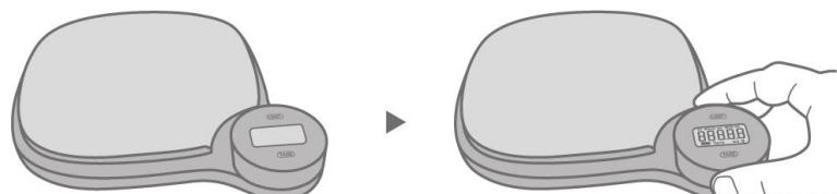
Поворачивайте регулятор по часовой стрелке до тех пор, пока на дисплее не появится значение 0.
