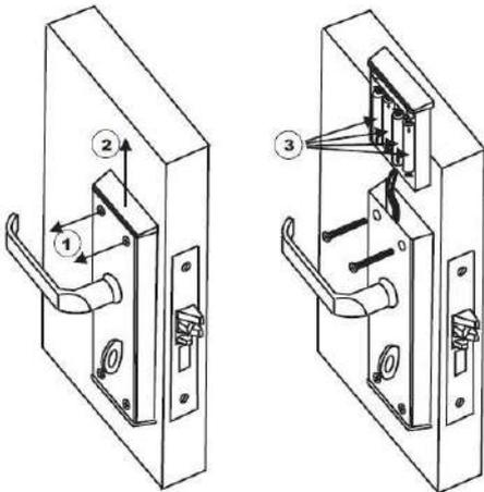
Замок питается от четырех элементов типа АА 1.5V (пальчиковые батарейки). Для более длительного использования рекомендуются элементы с максимальным запасом емкости.
