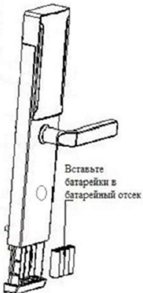
Замок питается от четырех элементов типа АА 1.5V (пальчиковые батарейки). Для более длительного использования рекомендуются элементы с максимальным запасом емкости.
