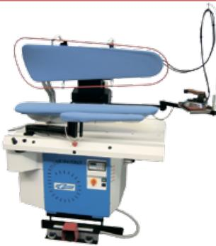
Гладильные прессы предназначены для глажения прямого и фасонного белья из хлопчатобумажных, шерстяных и синтетических тканей. Гладильная форма имеет закругленные углы, что удобно для глажения рукавов и брюк. Эффект отпаривания достигается за счет поступления пара в нижнюю и верхнюю формы, что способствует отсутствию на выглаженном изделии блеска. Имеется встроенный вентилятор для отвода выпариваемой влаги.
