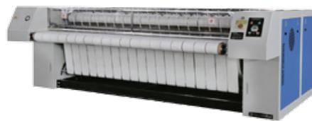
Каландры гладильные предназначены для сушки и глажения прямого белья с остаточной влажностью 50%, оснащены частотным преобразователем, что позволяет плавно регулировать скорость глажения.
