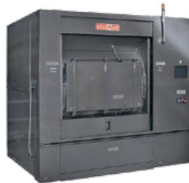
Промышленные стирально-отжимные машины «барьерного» типа с окончательным отжимом и автоматическим управлением предназначены для использования в медицинских учреждениях или в учреждениях атомной, химической, электронной промышленности и других отраслях. Конструкция машин предусматривает производить загрузку и выгрузку белья из разных зон (в помещениях, разделенных стенной) с целью соблюдения санитарно-гигиенических норм чистого белья. Таким образом, рабочие зоны разделены на «грязную» и «чистую».
