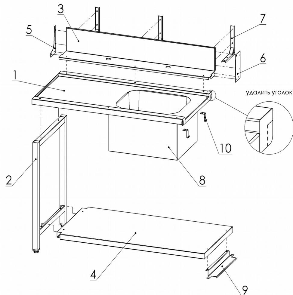
1. Прикрутить пластины (поз. 5) и (поз. 6) к фарту (поз. 3) при помощи винтов М5. Пластины имеют разную форму в зависимости от того с какой стороны будет установлен стол на посудомоечную машину.
