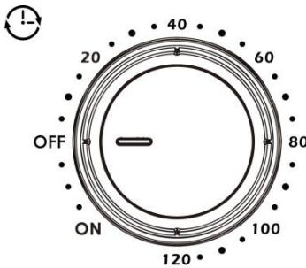
Vrid medurs för att ställa in önskad tid, kontrolllampen tänds. En signalton ljuder när tiden gått ut och apparaten slås från. Vrid reglaget till OFF för att stänga av apparaten. Om du vrider reglaget moturs till STAY ON, förblir apparaten påslagen tills den stängs av manuellt.
