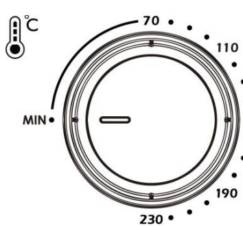
Предназначена для установки температуры термообработки, не для выключения устройства.
