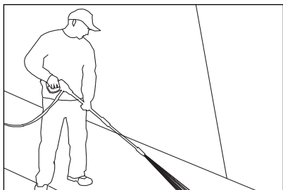
Рис. 6 - Оптимальный угол для распыления воды с очищаемой поверхности 45 градусов
