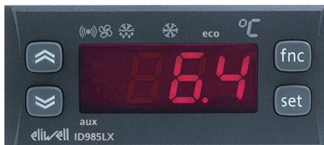
Рис. ПЗ. Лицевая панель контроллера ID 985 LX/К
