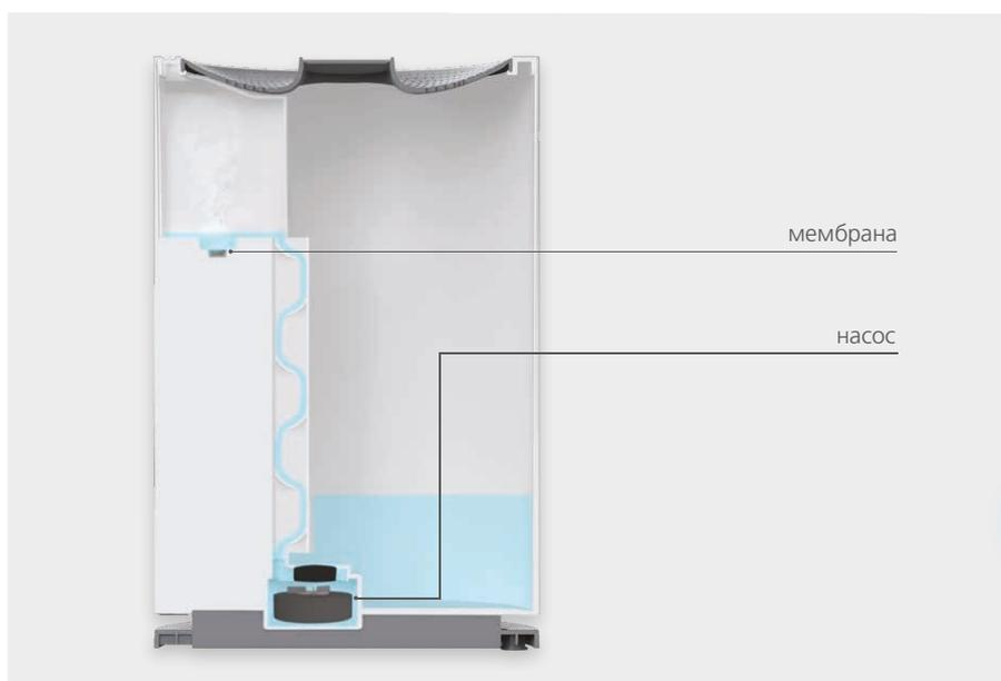
Уникальное расположение ультразвуковой мембраны и подача воды при помощи насоса
