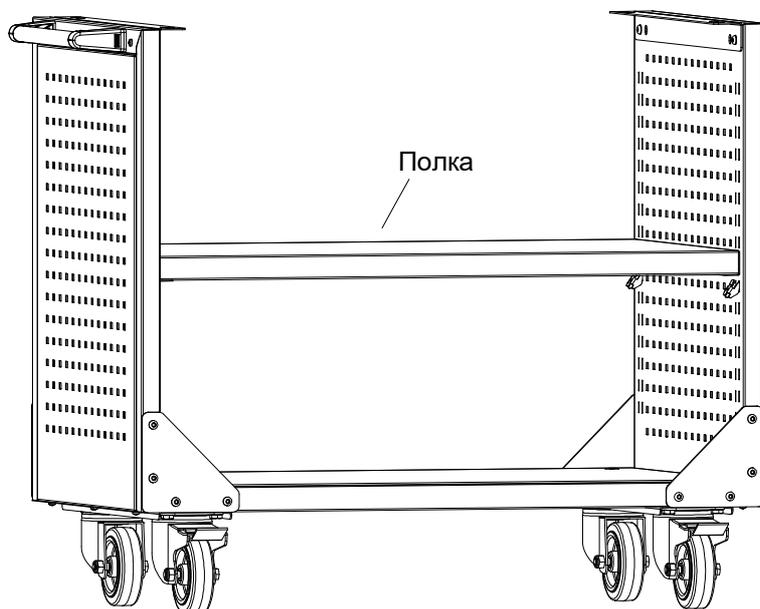
Завести зацепы в отверстия стенок боковых на нужной высоте и установить полку.
