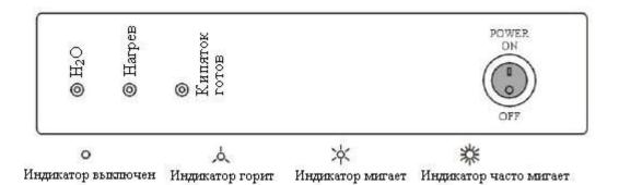
• При нажатии выключателя на панели управления загорается красный индикатор «**Harpeb**» и начинает мигать зеленый индикатор «**H<sub>2</sub>O**». В этот момент начинается заполнение кипятильника водой.
