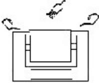
A schematic diagram of a machine with a lid. A hand is shown cleaning the top surface of the lid. The machine has a rectangular body with a lid on top and a base. | <p>После каждого использования машину необходимо очищать, крышка дежи должна быть закрыта. В машине не должно быть посторонних предметов, а также необходимо смазывать места соприкосновения для того, чтобы вы могли нормально использовать машину в следующий раз.</p> |
