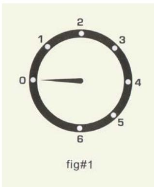
Внутренняя температура колеблется от 0 °C до 10 °C. Установить необходимую температуру Вы можете с помощью ручки термостата. Повернув ручку по часовой стрелке, от позиции 1 до 6, вы можете установить более низкую температуру внутри. Установите ручку в позицию 0 - устройство выключится. Пожалуйста, см. рис. № 1.
