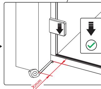
Вставьте петлю в нижнюю часть прорези и зафиксируйте положение.
