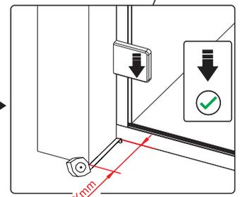
Вставьте петлю в нижнюю часть прорези и зафиксируйте положение
