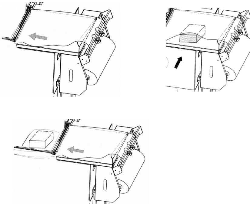
Для проведения процесса запаивания на моделях TMC 58-N оператор должен вручную закрыть рамку запаивания (прилагаемое давление - приблизит. 5 кг); во время процесса запаивания рамка будет удерживаться магнитным держателем.
