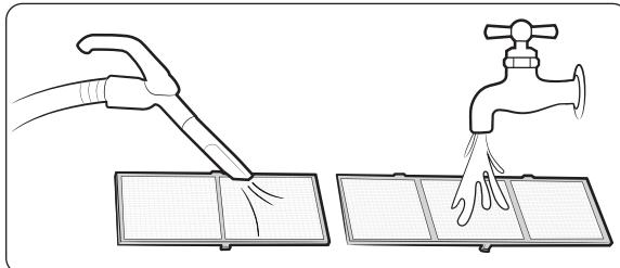
Очистите воздушный фильтр пылесосом или мягкой щеткой. Если пыли слишком много, промойте ее под струей воды и высушите в проветриваемом помещении.
