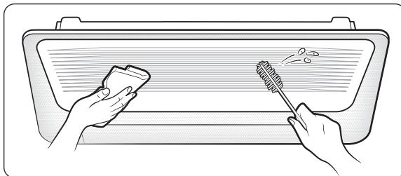
Протрите поверхность внутреннего блока слегка влажной теплой тканью.
