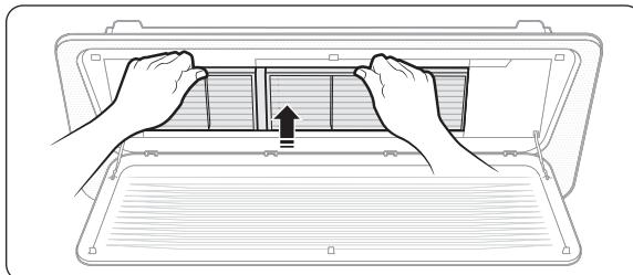
Для сборки воздушного фильтра, выполните в обратном порядке все совершенные вами действия во время отсоединения фильтра.
