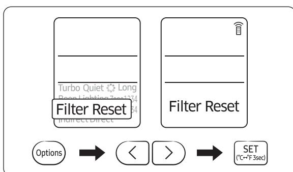
После очистки и сборки воздушного фильтра установите напоминание об очистке следующим образом:
