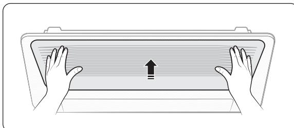
**4** Повторная установка воздушного фильтра (использование проводного пульта дистанционного управления является дополнительной опцией.)
