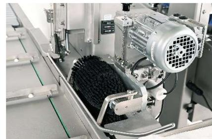
Полный комплект включает хлеборезку, устройство раздува пакетов и горизонтальный конвейер с системой закрытия пакетов.
