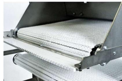
Простая сборка и разборка загрузочных и разгрузочных модульных ремней для чистки и обслуживания.
