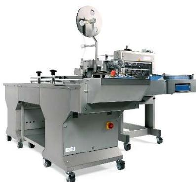
Упаковочная линия оснащена блокируемыми поворотными колесами для легкого позиционирования.
