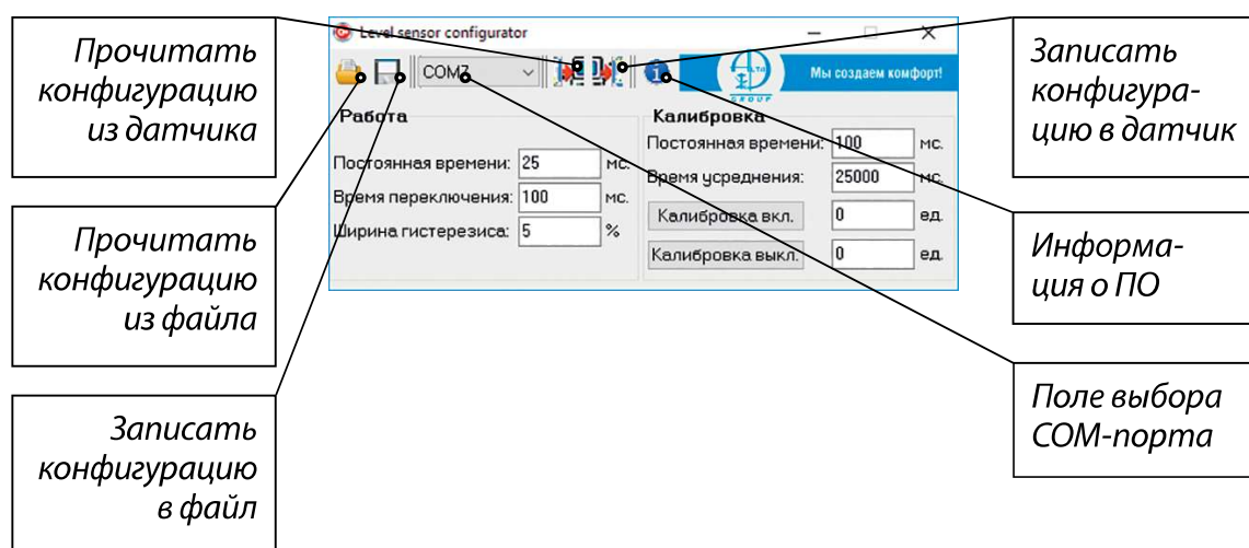
Рисунок 4. Внешний вид окна интерфейса ПО для конфигурирования Сигнализатора уровня
