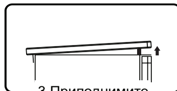
3. Приподнимите верхнюю крышку спереди и установите упор.
