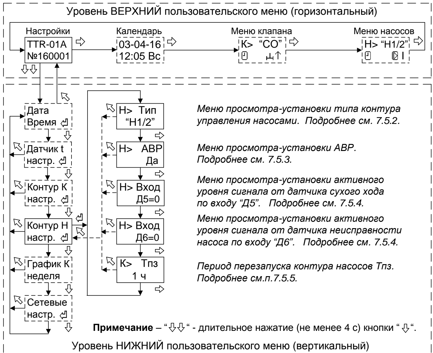
Рисунок 9 - Структура меню настройки параметров контура управления насосами.
