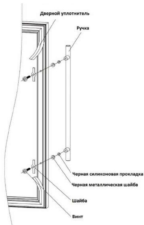
2. Следуйте приведенной ниже схеме, чтобы установить все принадлежности для крепления ручки в необходимые отверстия:
