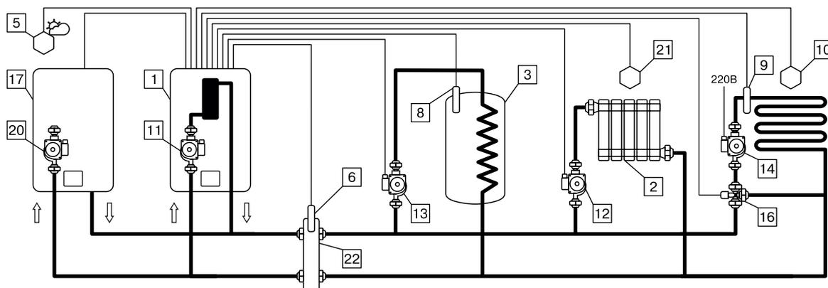
**Схема 3.1. Совместная работа ведущего котла с электродом в режиме каскад-ведомый с активированной функцией «Гидроразделитель», насосом 2 в режиме ГВС или отопление, насосом 3 в режиме отопление и клапаном в режиме работы «Смешивающий».**
