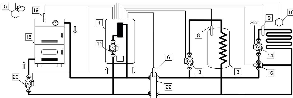
**Схема 3.2. Совместная работа основного котла с электродом в режиме вспомогательный с активированной функцией «Гидроразделитель», насосом 2 в режиме ГВС или отопление и клапаном в режиме работы «Смешивающий».**
