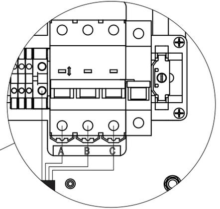
Колодка для подключения ИБП
