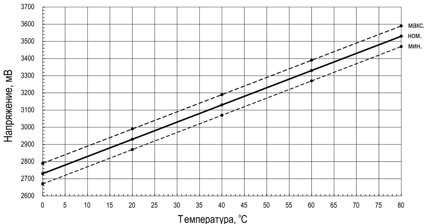
**Рис.11 Напряжение на датчике в зависимости от температуры**
