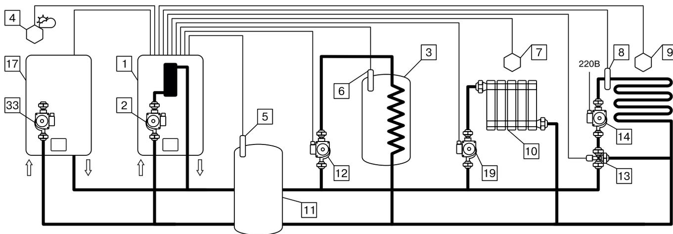
**Схема 4.3. Совместная работа основного котла с электродом в режиме «Каскад-ведомый» с активированной функцией «Бак аккумулятор», насосом 2 в режиме ГВС или отопление, насосом 3 в режиме отопление и клапаном в режиме работы «Смешивающий».**
