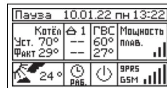
7.3.13.1.2. Проверьте уровень сигнала сети GSM в пункте меню «GSM/LAN модуль → Уровень сигнала». Для надежной связи уровень должен быть в пределах 3-5 единиц. Если уровень меньше 3 единиц то предпримите меры для улучшения качества сигнала, например переносом GSM-антенны в другое место. Если вместо уровня отображается прочерк «-», то значит связь отсутствует и вам следует обратиться в сервисную службу компании ZOTA по телефону (391) 219-11-41.
