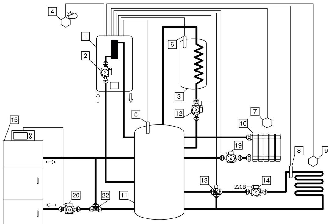
**Схема 4. Совместная работа основного котла с блоком управления с электрокотлом с активированной функцией «Бак аккумулятор», насосом 2 в режиме ГВС или отопление, насосом 3 в режиме отопление и клапаном в режиме работы «Смешивающий».**
