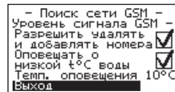
7.3.13.1.3. Установите галочку в пункте меню «GSM/LAN модуль → Разрешить удалять и добавлять номера».
