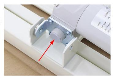
4. Вращайте ручку гибридного привода против часовой стрелки до тех пор, пока отверстия в кронштейне линейного актуатора не совместятся с отверстиями в кронштейне крепления актуатора на раме кровати. Соедините кронштейны болтами с гайкой. Верните заглушку линейного актуатора на место.
