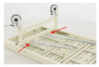
Вставьте ручку механического привода в отверстие, предусмотренное на раме кровати, 3. eë винтовым приводом стальным установите соедините механическим пальцем И предохранительный шплинт отверстие пальца. на конце В
