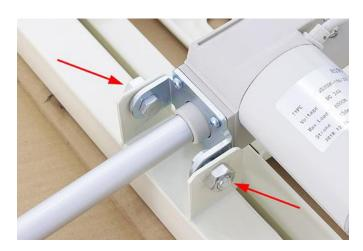
5. Зафиксируйте блок управления кроватью на линейном актуаторе с помощью салазок на блоке управления и на актуаторе.
