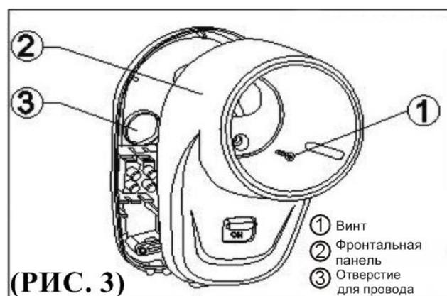
2) Удалите пластиковую заглушку с отверстия для провода № 3 (рис. 3). Пропустите выведенный из стены сетевой кабель через отверстие № 3 и соедините его с электрическим портом. Для правильного подсоединения проводов следуйте указателям N (нейтраль) и L (фаза) на контактах.
