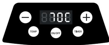
**⏻** - Нажатие данной кнопки запускает и останавливает процесс сушки. Исходные настройки устройства составляют 50 °C и 10 часов.
