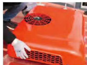
3. Установить накрышный блок
