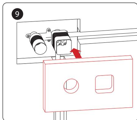
Используя шаблон, вырежьте отверстие в плитке, затем соответствующим образом уложите плитку. Не снимайте защитные крышки с блока смесителя до завершения всех отделочных работ. Это защитит блок управления от попадания пыли.
