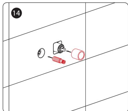
Наденьте декоративную гильзу на картридж. Прикрутите соединительную трубку в резьбовое отверстие. Накрутите гайку на трубку и зафиксируйте ее с помощью сервисного ключа.
