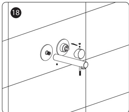
Прикрутите ручку смесителя шестигранным ключом. Наденьте излив на соединительную трубку, зафиксируйте излив с помощью шестигранного ключа.
