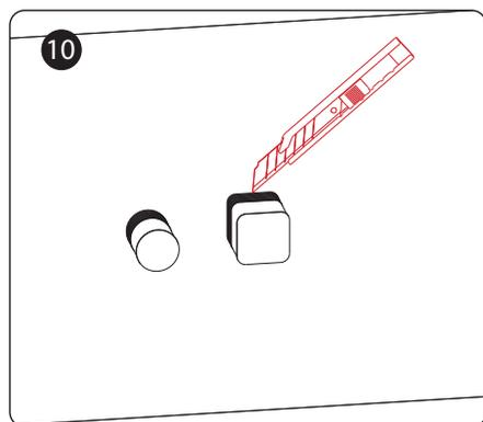
Следуя линии разреза на коробке, отрежьте выступающую часть коробки.
