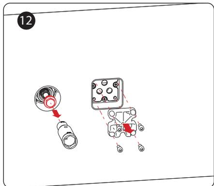
Извлеките пробку с помощью сервисного ключа, а затем снимите защитную заглушку картриджа. Прикрутите картридж к блоку винтами.
