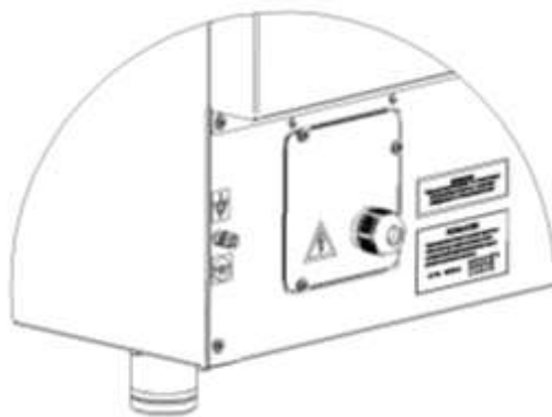
Рис. 4 - Место подключения ЭГЛ-40/1Н-00, ЭГЛ-40/1Н-01, ЭГЛ-80/2Н-00, ЭГЛ-80/2Н-01
