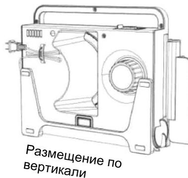
11. Два способа размещения: 1. Под углом; 2. По вертикали (необходимо убрать опору). При частом использовании устройства рекомендуется использовать положение под углом и не использовать вертикальное положение в течение длительного времени. При выборе вертикального расположения соблюдайте инструкции, приведенные ниже.
