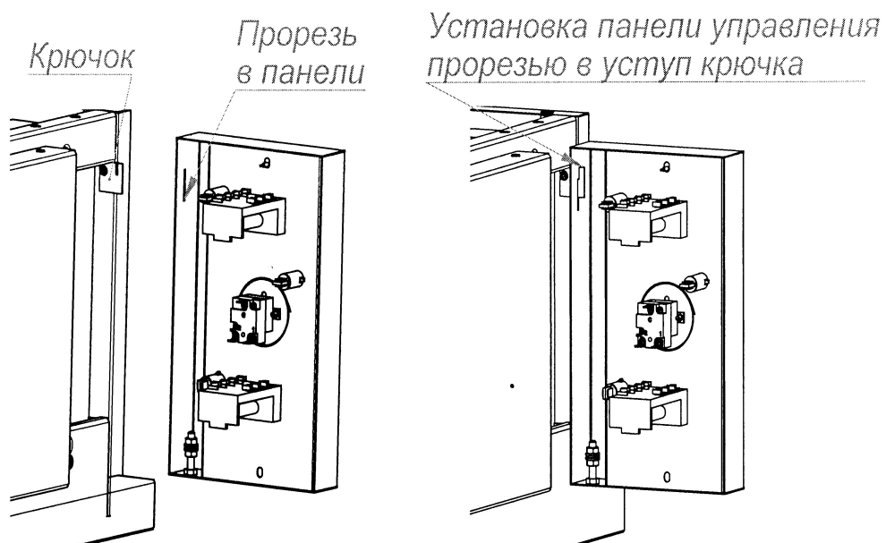
Рис. 4 Схема установки панели управления при ТО
