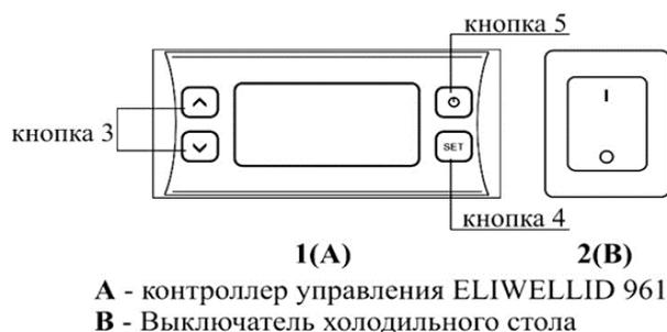
Во время нормальной работы дисплей показывает текущую температуру рабочего пространства охлаждаемой витрины. В случае какого-либо сбоя экран полностью погаснет, либо индицируется ошибка с префиксом «Е».
