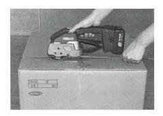
5. После окончания спаивания, светодиод мигает в течение примерно, двух секунд. Не снимайте инструмент с ленты в это время.
