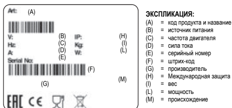
рис. № 4 - Техническая дощечка-серийный номер
