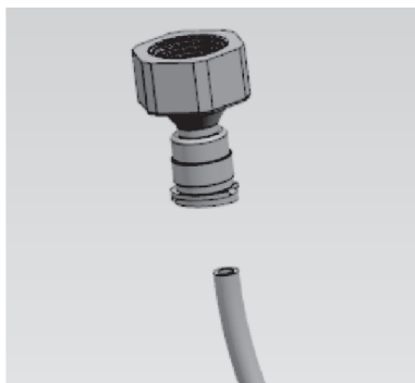
7. Suv quvurining uchi ulagichga kiritilganligiga ishonch hosil qiling.
