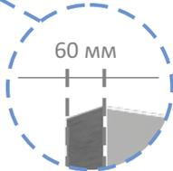
Теплоизоляция цельнозаливного корпуса 60 мм.
