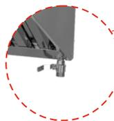
Конструкция имеет сливной кран.
