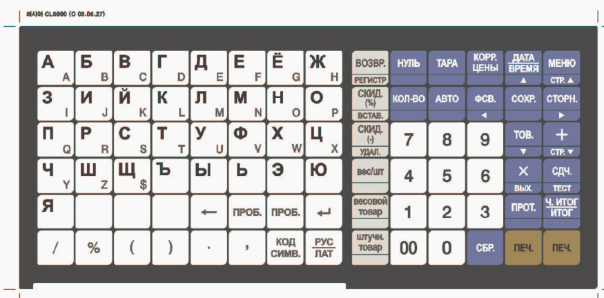
Рисунок 1.7 – Вид клавиатуры весов модификации без стойки
