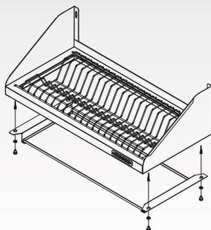
Установить кронштейны поддона при помощи болтов
