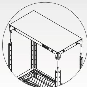
Установить полку при помощи болтов к стойке стеллажа
