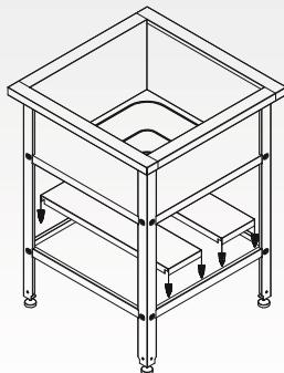
Установить полку-настил на нижнюю рамку каркаса ванны (съемная конструкция).
