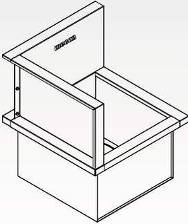
Рекомендуем обработать место примыкания облицовки к моечному отделению герметиком.
