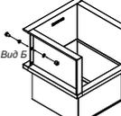
3. Соединить две боковые панели с задней панелью при помощи болтов M6x10
