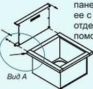
1. Установить заднюю панель и соединить ее с моечным отделением при помощи болтов M6x10
