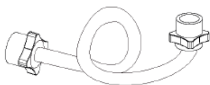
Шланг подачи воды
