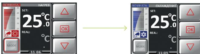
Далее, при выполнении условия – заданная температура меньше температуры воздуха в канале ( $T_{set} < T_{real}$ ), через технологическую задержку в 2-3 минуты система перейдет в «РЕЖИМ ОХЛАЖДЕНИЯ» и поддержания установленной температуры включением и отключением компрессорно-конденсаторного блока (кондиционера).
