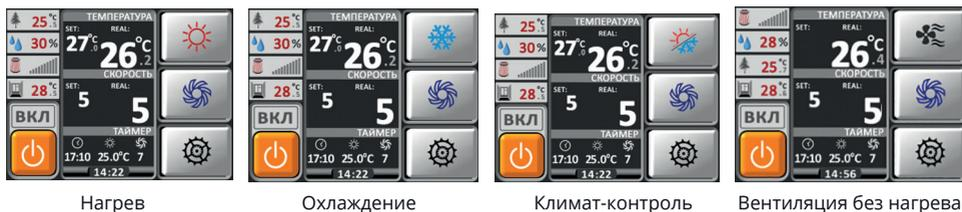
**ВНИМАНИЕ!** Для полного отключения охлаждающего контура (ККБ) при переводе системы в «РЕЖИМ НАГРЕВА» после нажатия (удержания в течении 3-5 секунд) кнопки «MODE» может потребоваться перезапуск (отключение и включение с пульта) установки.
